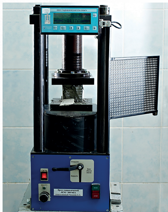
Рис. 1. Пресс гидравлический для определения прочности
