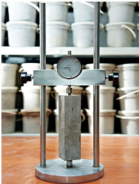
Рис. 2. Устройство для определения деформаций усадки (расширения)
