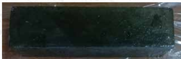
Рис. 9 – Внешний вид образца после хранения в машинном масле
