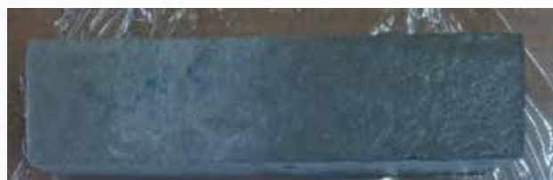
Рис. 3 – Внешний вид образца после хранения в растворе сульфата аммония
