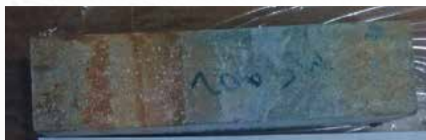
Рис. 4 – Внешний вид образца после хранения в растворе гидроксида натрия
