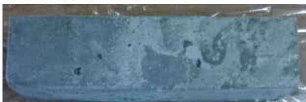
Рис. 8 – Внешний вид образца после хранения в растворе сульфата натрия
