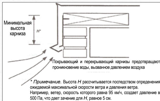
Рис. 1.4. Карниз, используемый для предотвращения проникновения воды под давлением ветра.
