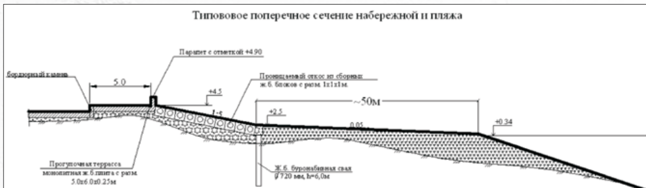
Рис. 7. Проектный разрез пляжа и набережной в Имеретинской низменности
