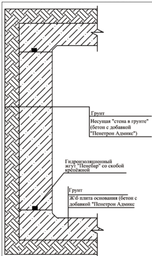
Рисунок 3 – Гидроизоляция ограждающих конструкций подземного сооружения на стадии строительства с применением гидроизоляционной добавки «Пенетрон Адмикс» и гидроизоляционного жгута «Пенебар».
