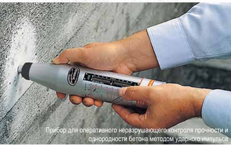
Прибор для оперативного неразрушающего контроля прочности и однородности бетона методом ударного импульса
