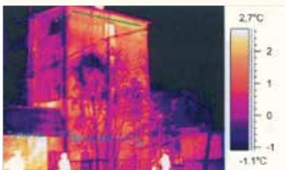
Сравнение со стандартной изоляцией (температура на поверхности одинакова)
