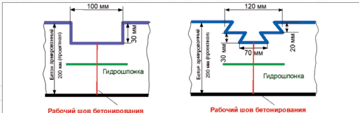
Схема расшивки рабочих швов бетонирования: ровным резом и в форме ласточкина хвоста
