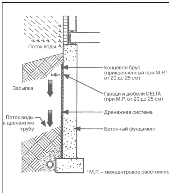
Рис. 4. Упрощенная схема конструкции сборной дренажной системы
