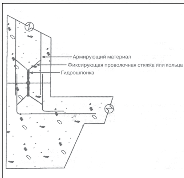
Рис. 2. Установка и закрепление гидрошпонок в строительных швах
