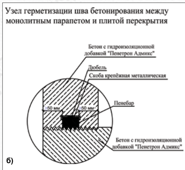
Рисунок 4. Герметизация швов бетонирования
