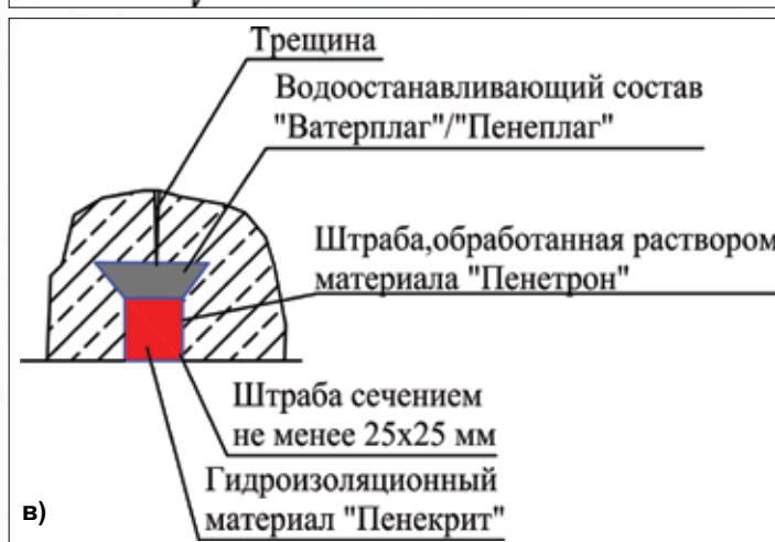
Рисунок 5. Устранение напорных течей, герметизация трещин
