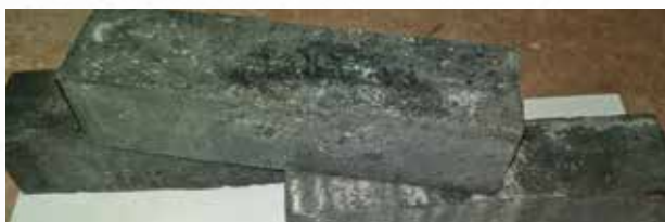
Рис. 10 – Внешний вид образца после хранения в морской воде
