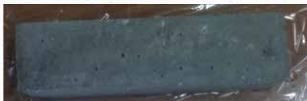
Рис. 5 – Внешний вид образца после хранения в растворе хлорида натрия
