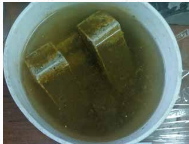
Рис. 12 – Хранение в растворе серной кислоты
