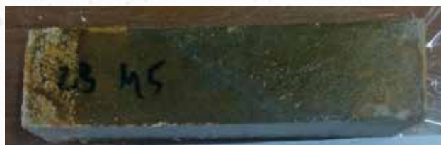
Рис. 7 – Внешний вид образца после хранения в растворе серной кислоты
