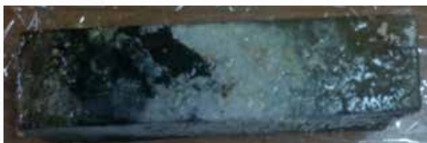
Рис. 6 – Внешний вид образца после хранения в растворе лимонной кислоты
