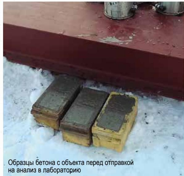
Образцы бетона с объекта перед отправкой на анализ в лабораторию
